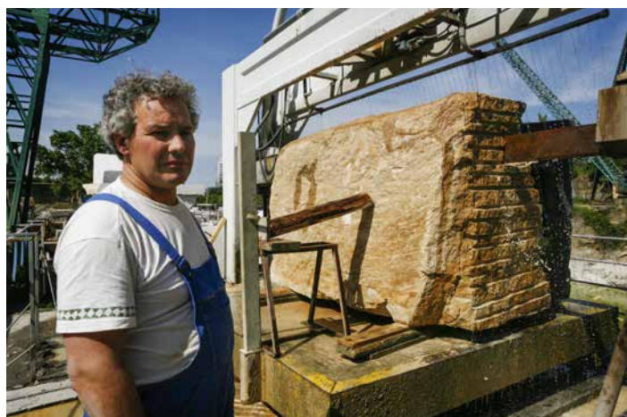
Petr Vána přihlíží řezání kamene na hlavní podstavec sloupu (květen 2008)
